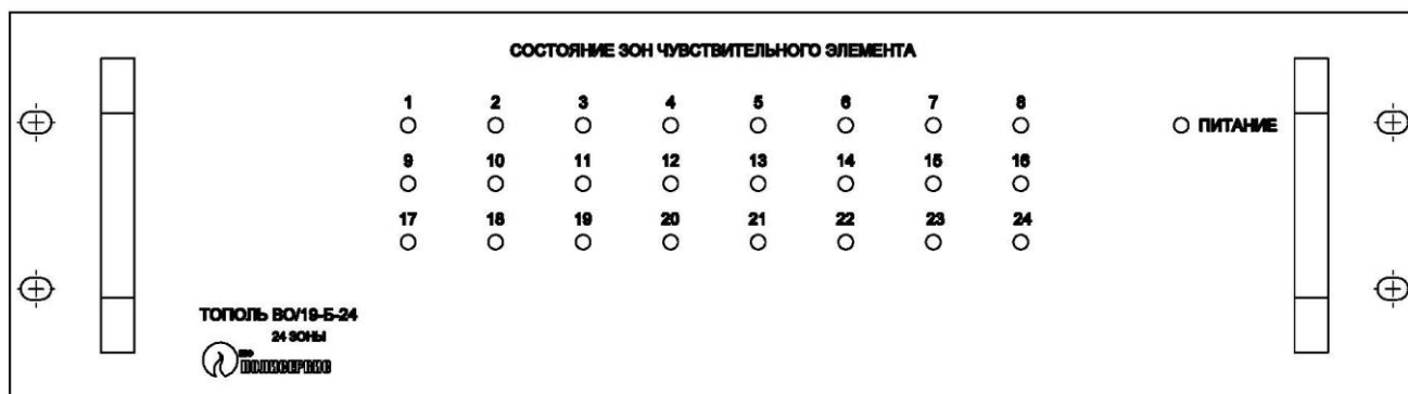
Рисунок 3 - Расположение единичных индикаторов на лицевой панели БОС
